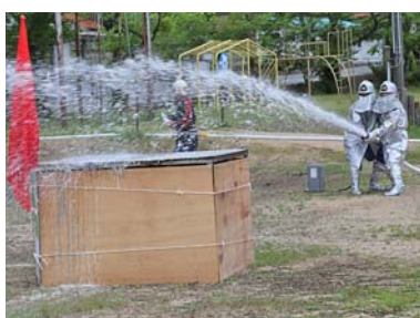
泡消火器での車輦火災消火
